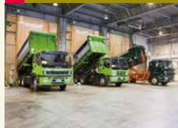
清掃工場でごみを燃やした後に出る焼却灰を受け入れます。（飛灰は専用貯留タンクに入ります。）
